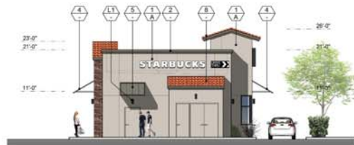
2 SOUTH ELEVATION SCALE: 1/8" = 1'-0"
