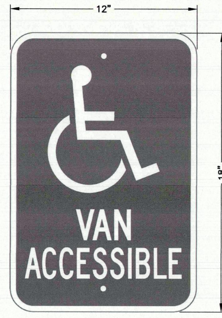
ADA-VAN ADA SIGNAGE DETAIL ② SCALE: N.T.S.
